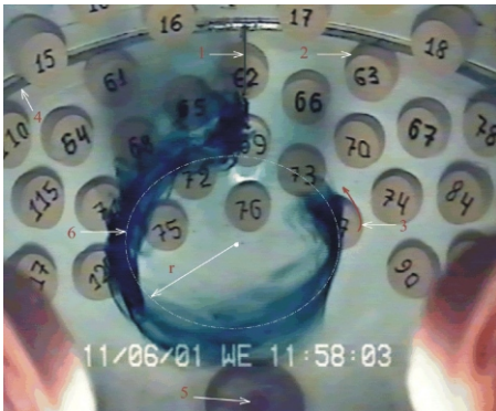
Рис. 3.1. Кольцевая структура во вращающейся жидкости. 1 - игла инжектора, 2 - резиновый диск, 3 - направление движения окрашенной жидкости относительно сосуда, 4 - экватор сосуда (технологическое соединительное кольцо), 5 - "южный полюс" сосуда, 6 - проекция структуры на экваториальную плоскость.
