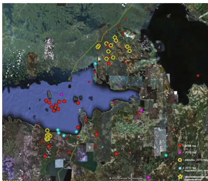
Пример схемы расположения источников сигналов, зарегистрированных малоапертурной сейсмической группой. Ленинградская область: мониторинг площадки ЛАЭС-2. Кружки красного и розового цвета - эндогенные сигналы; желтые окружности - взрывы; голубым цветом нанесены сигналы от карьерных взрывов.
