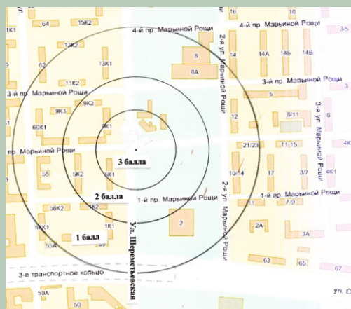
Очередность подрыва зарядов и вертикальные колебания в сейсмозрывной волне. Справа интенсивность сейсмического воздействия взрывов метростроя на кварталы города.
