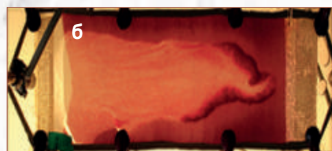
Фронт плавления с частичной оторочкой, доля парафина 0,3
