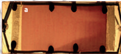
Фронт плавления без оторочки, доля парафина 0,2
