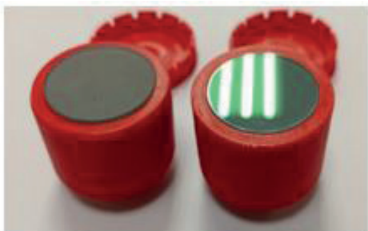
Фотографии 30 мм КВФ, изготовленных на 3Д принтере
